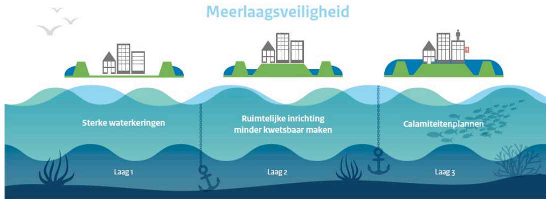
Figuur van de lagenbenadering van het meerlaagsveiligheidsbeleid: bescherming door waterkeringen, ruimtelijke maatregelen en calamiteitenplannen, rond 2005 © Rijkswaterstaat
